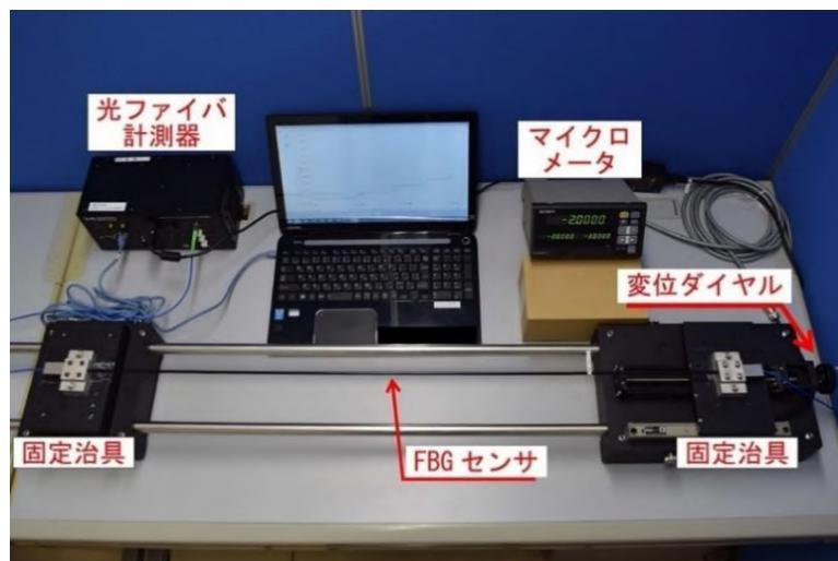
図 1.3-2 検証試験のセットアップ例
